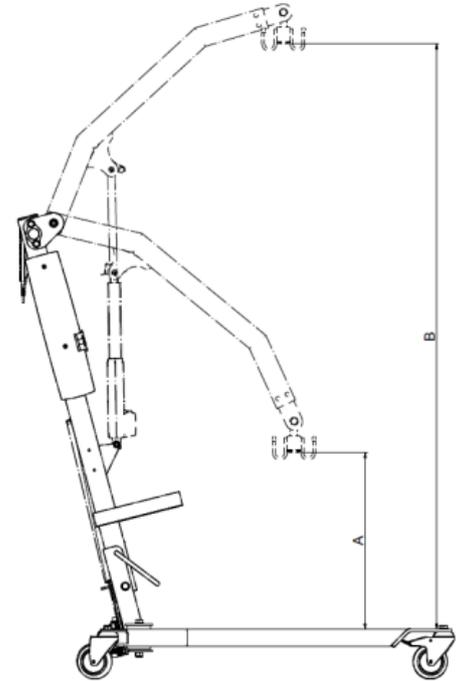
(2) *Descenso: Presionar el botón de descenso, según la figura del propio control. Si el comando presentara algún desperfecto y dejara de funcionar cuando el paciente está suspendido, hay un botón en el módulo de batería, indicado con un triángulo invertido, que permite bajar. Tener en cuenta que no podrá volver a subirse por lo que es necesario posicionar al paciente en el lugar que vaya a quedar, antes de hacer el descenso desde ese botón.*
